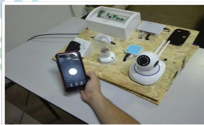
Rajah 2.1 : Pengujian perkakasan dan perisian sedang dilakukan menggunakan telefon pintar
